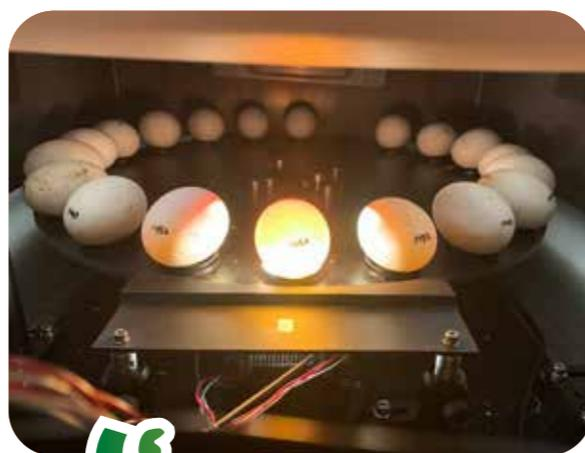
En 2024, des travaux d'aménagement du couvoir d'Aignan (32) ont été menés pour accueillir un robot capable de repérer les canetons mâles à travers la coquille. Il manipulera 20 000 œufs à l'heure, pour un taux de réussite de 95%. La mise en service aura lieu à l'automne 2024. Il permettra de valoriser uniquement les animaux offrant un débouché commercial.
